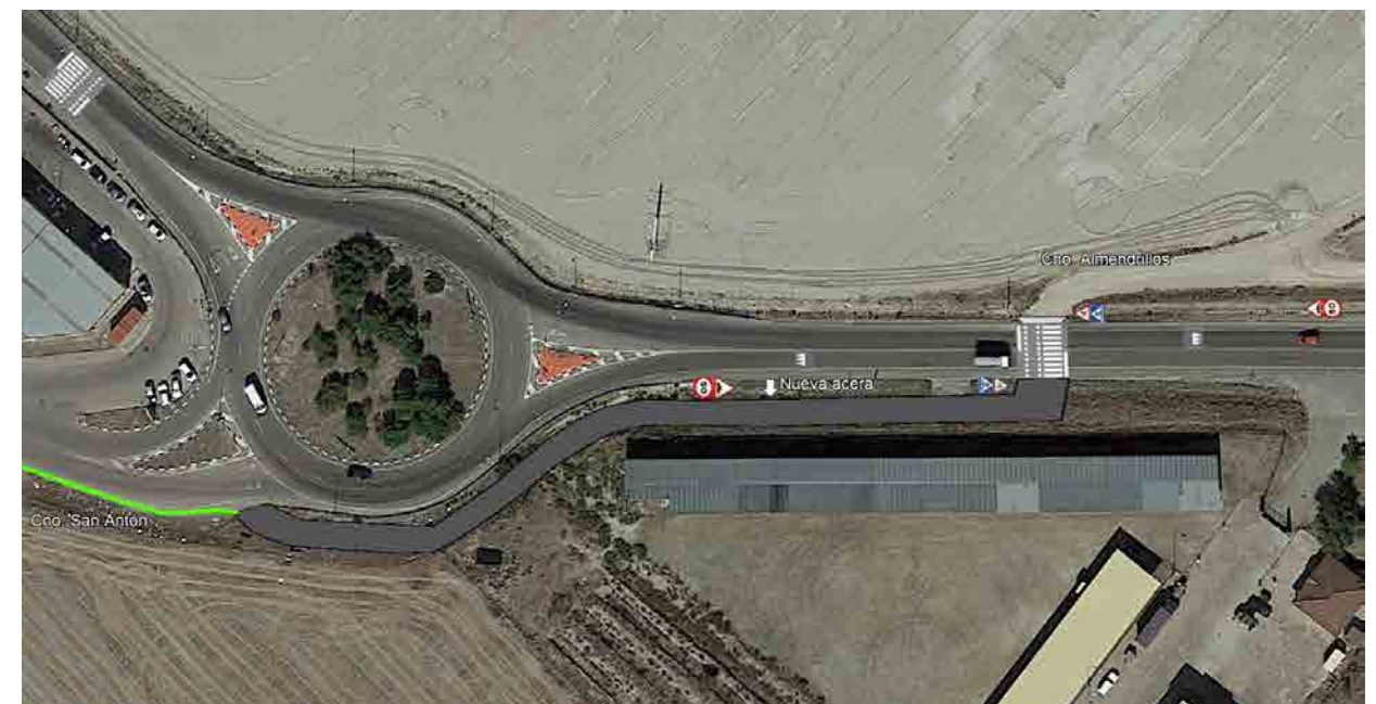
Propuesta de paso de peatones. En verde se representa el itinerario ya existente y al que hay que dar continuidad
