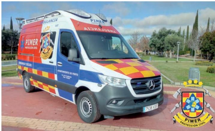
Cuenta con un carrozado que cumple con la norma contra impactos UNE 1789, diseñado conforme a las necesidades y las propuestas efectuadas por los TAE (Técnicos Auxiliares de Emergencias) de PIMER-Protección Civil de Pinto. El diseño exterior de uso de luces está adaptado a la nueva normativa sobre V1
