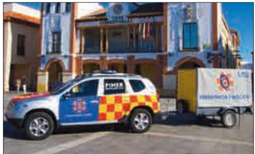
mensajes y advertencias, como por ejemplo señalar con seguridad un accidente de tráfico. En cuanto al remolque, soporta un peso hasta 750 kg. y en él se dispondrán elementos de apoyo para tareas de emergencias y rescate. También servirá para transportar materiales, un puesto sanitario o puesto de mando.
